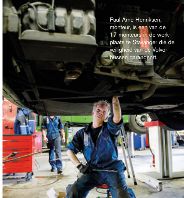
Niet vergeten te smeren! Gunnar Arne Sømme reviseert de achteras. Onderhoudswerk, reparaties en vervanging van onderdelen zijn geregeld in het contract tussen Volvo en Veolia.
