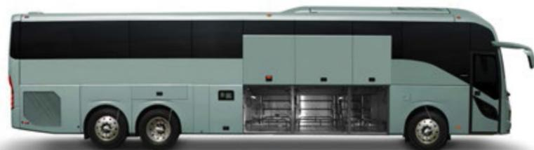
**El compartimiento de equipaje** ofrece un total de hasta 13.65 m<sup>3</sup> en su versión de 15m. Así que no importa qué quieran traer los pasajeros, hay mucho lugar. Los paneles de las puertas se abren ampliamente para simplificar la carga y descarga.
