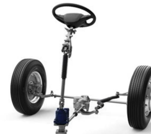
*Volvo Dynamic Steering (dirección dinámica) presenta un potente motor eléctrico que asiste al mecanismo de dirección. El conductor se beneficia de un incremento en la estabilidad, menor tensión y la capacidad única de regreso a la posición cero del volante.*
