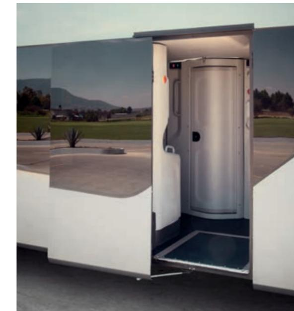
**El Volvo 9800 DD** es el único autobús con rampa de acceso para silla de ruedas. Sin embargo, todos los pasajeros se benefician con la amplitud de la puerta para un fácil acceso.
