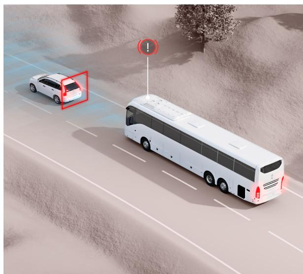
Le processus de freinage commence par un pré-freinage de  $-2,5 \text{ m/s}^2$  à  $-3,5 \text{ m/s}^2$ , tandis que le freinage d'urgence peut atteindre  $-8 \text{ m/s}^2$ . Le freinage se poursuit jusqu'à l'absence complète de risque de collision. Le freinage peut être désactivé par le conducteur en appuyant sur l'accélérateur.
