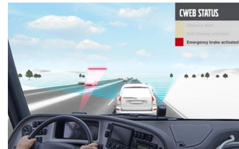
**Advertencia de colisión con frenado de emergencia (CW-EB)** detecta los vehículos que circulan por delante y avisa al conductor cuando existe un riesgo de colisión. Si se ignora la advertencia, esta se escala y se procede a un suave frenado en primer lugar, seguido de un frenado de emergencia con la máxima deceleración.
