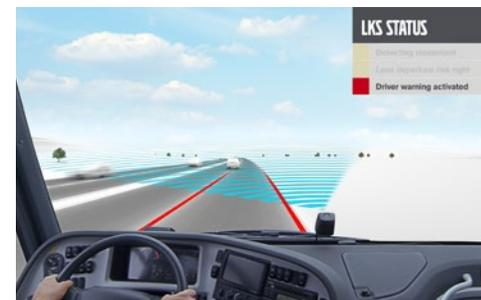
**Asistencia para permanencia en el carril (LKS)** controla las marcas de señalización de los carriles y alerta al conductor cuando se identifica un riesgo de desviación involuntaria. La advertencia se ofrece a través de una vibración en el asiento o una señal acústica.
